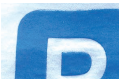
「EG0290 NPTジェルクリアー」を使用した 透明厚盛印刷
