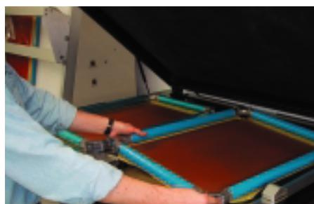
2. 版枠をマスターフレームにセットします。マスターフレームの3つの位置決めガイドブロックが露光時のパキューム中でも版枠とフィルムをしっかりと指定位置に固定し、焼付けされます。
