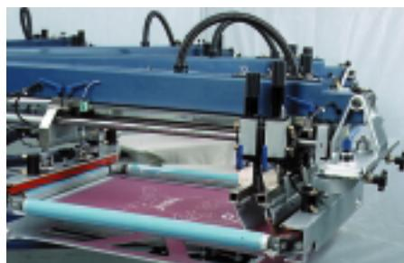
4. パレットステーションを上昇させ、版枠を位置合わせパレットのストップガイドブロックにしっかりと固定させロックします。その繰り返しで全ての版枠をロックするだけで、露光時に合わせた位置合わせが再現されます。
