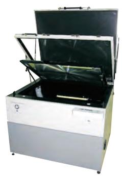
■ スクリーン枠用露光機 煽り型
