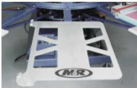
3. 印刷機用位置決めパレットを印刷機にセットします。位置決めパレットの3つのストップブロックガイドは製版用マスター位置合わせフレームのガイドと完全に一致しており、製版時の位置合わせが再現されます。
