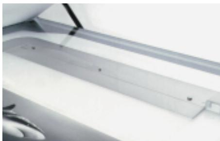
1. トライロックの製版用マスターフレームを露光機のガラス面に置きます。あらかじめポジフィルムが貼ってあるキャリアシートをピンバーにセットします。ポジフィルムの下部は露光機のガラス面にテープ止めします。
