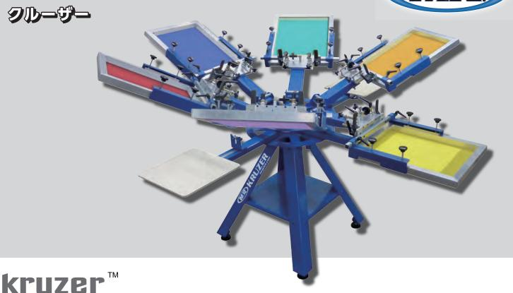
クルーザーは現行のM&Rラインナップで最もお手頃な入門モデルであり、軽量な手刷り印刷機です。 サイドクランプを標準装備、クルーザー独自のレバー調整システムにより、様々なシャツの厚みに合わせ 簡単にオフコンタクトの調整が可能です。
